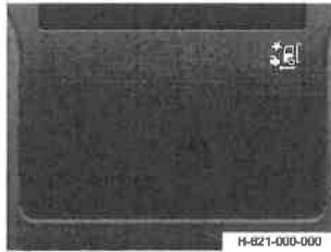
Die Kontrollleuchte „EBA“ leuchtet.
