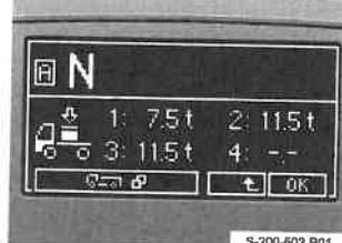
Beispiel für die Anzeige für Luft-Luft-Federung. Die Achsen des Fahrzeugs sind von vorne nach hinten nummeriert.
