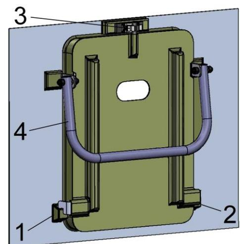
Die Kunststoffabdeckung kann seitlich an der Umwehrung in die Halterung eingeklinkt werden. Die Montage erfolgt in umgekehrter Reihenfolge.
