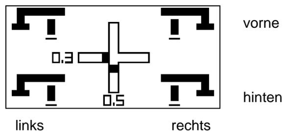
Die Displayseite zeigt die aktuelle Abstützsituation an, mit welcher der Steiger aufgestellt ist. Das Beispiel zeigt:
