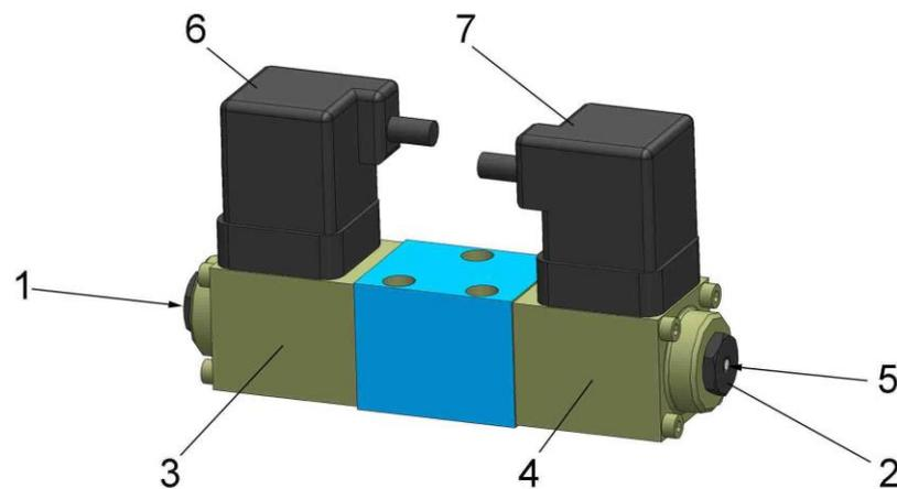
1. Handnotbetätigung links. Aufnahme für Betätigungsschraube der Magnetarretierung.
