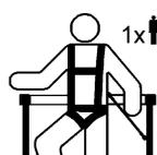
⇒ Nur für Rückhaltesysteme. Anschlagpunkt (Halteöse) für ein Rückhaltesystem gegen Absturz. In diesem Beispiel eine Person je Anschlagpunkt.
