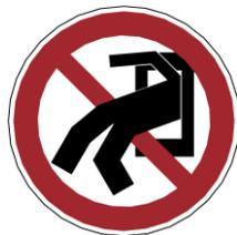
⇒ Ein- und Aussteigen durch die Montageöffnung der Arbeitsbühne ist verboten! (bei Arbeitsbühnen mit Montageöffnung, Sonderausstattung)
