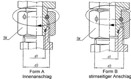
Dichtkegel der Verschraubung in den Konus einführen und fest andrücken. Überwurfmutter handfest anziehen. Danach die Überwurfmutter mit einem definierten Drehmoment oder mit einer weiteren „Wert X“ - Umdrehung entsprechend nachstehender Tabelle weiter festzuziehen. Beim Anziehen der Überwurfmutter den Verschraubungsstutzen mit einem Schraubenschlüssel gegenhalten.
