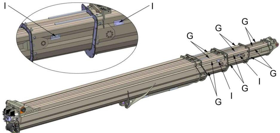
Das Teleskop zum Abschmieren (Fetten) so weit wie möglich ausfahren und die Gleitflächen („G“) dünn, z. B. mit Hilfe eines Heizkörperpinsels einfetten.
