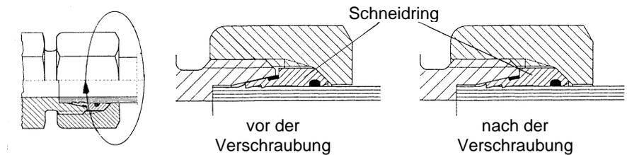
Der Schneidring wird auf Block montiert. Beim Anziehen der Überwurfmutter den Verschraubungsstutzen mit einem Schraubenschlüssel gegenhalten.
