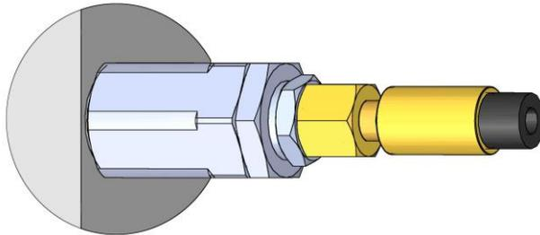
Das Filter befindet sich am „P“-Leistungsanschluss des Ventilblocks. **Achtung: Die Leitung muss während des Austauschs drucklos sein!** Filtergehäuse nach Lösen der Schlauch-Verschraubung vom Ventilblock abschrauben.
