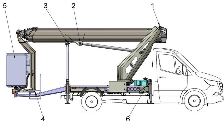
Der Ruthmann-Steiger TBR 230 wird durch zwei voneinander unabhängige, in Reihe geschaltete Isolierstrecken gegen Erde isoliert.
